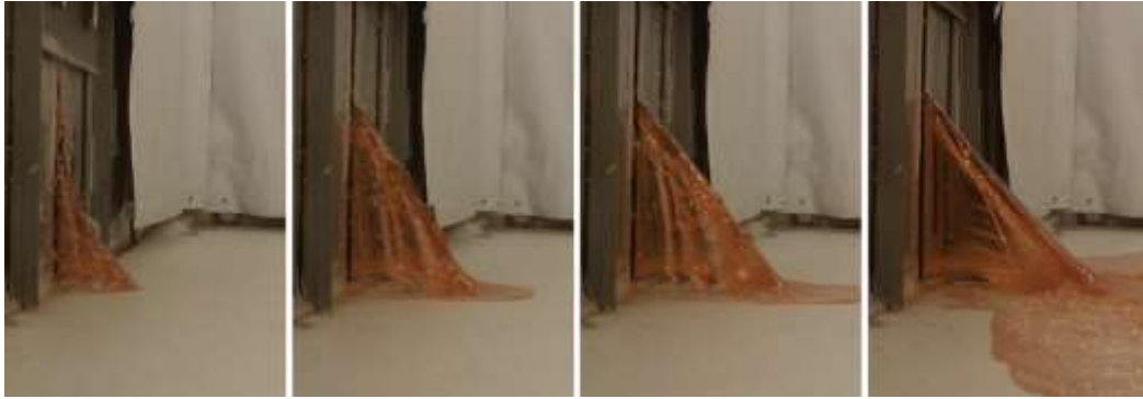
Figura 60: vista laterale della vena effluente dal serbatoio agli istanti 0.08 s, 0.13 s, 0.25 s e 0.42 s dall'inizio del sollevamento della paratoia.
