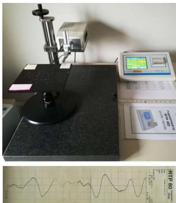
Figura 28: rugosimetro utilizzato per la misura della rugosità superficiale lineare, sul piano di misura sono presenti i 3 provini utilizzati. In basso il risultato (profilo della superficie lungo un segmento) di una delle prove eseguite.
