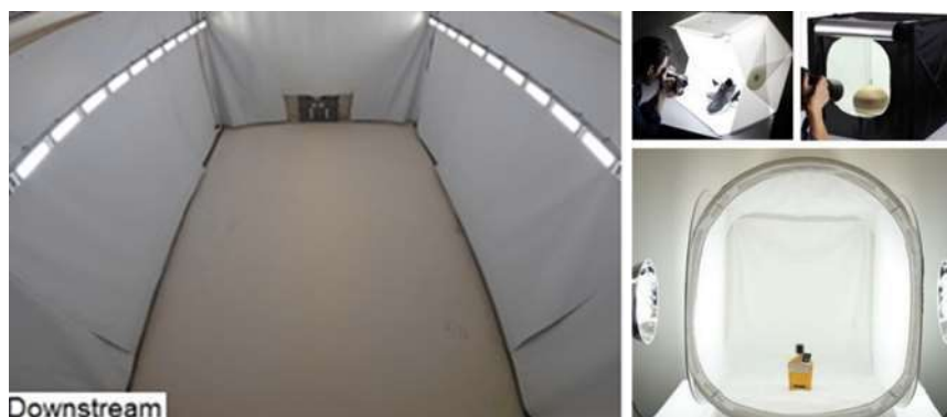
Figura 32: esempi di light-box tratti dal web (destra) e vista dell'interno della gabbia di luce realizzata intorno al piano di misura (sinistra), si vedono le due file di fari e la paratoia.
