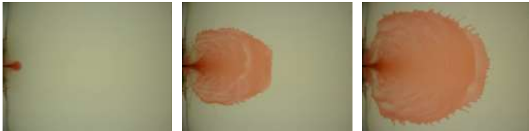
Figura 64: esempio di evoluzione di un'onda di dam-break su fondo liscio ( H_0=0.30\text{m} ); 3 scatti a circa 0.8s l'uno dall'altro a partire dal secondo scatto successivo al sollevamento della paratoia (5fps).
